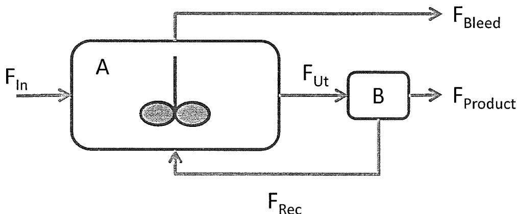
Vid ett sådant försök var det färsk inflödet 5 liter/timme. Halten  $S_{in}$  i inflödet  $F_{in}$  var 100 g/l. Den totala volymen cellsuspension i bioreaktorn (A), recirkulationsloopen och filterenheten (B) var 2.5 liter. För att hålla konstant volym togs ett flöde motsvarande 1% av det färsk inflödet ut direkt från bioreaktorn genom en avtappning, en s.k. bleed ( $F_{Bleed}$ ).
