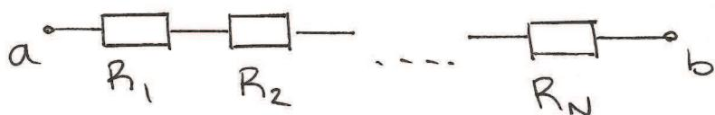
Ersättningsresistansen:  $R_{ab} = R_1 + R_2 + \dots + R_N$
