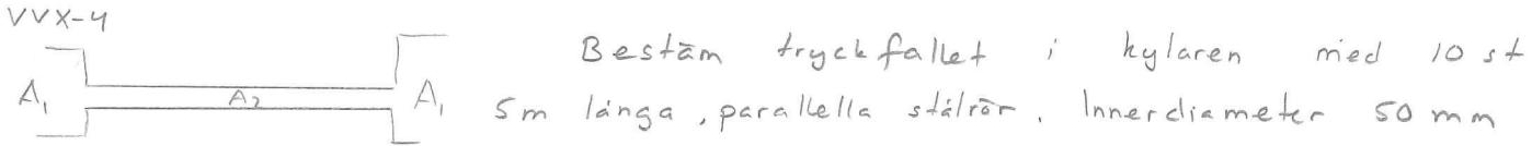
Bestäm tryckfallet i kylaren med 10 st 5m långa, parallella stålör. Innerdiameter 50 mm
