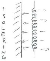
Eftersom plåtens baksida är isolerad kommer energin som absorberas strålas ut igen (inga förluster).
