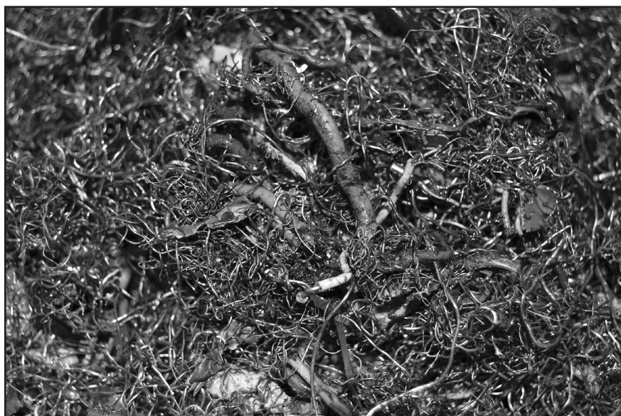
Avfallsindustrin har två tillvägagångssätt för att behandla metallskrot. Antingen bankas skräpet, såsom kylskåp och Slotsburkar, ner i småbitar för att sorteras eller så eldas det upp. Så här ser den utsorterade kopparn ut.
